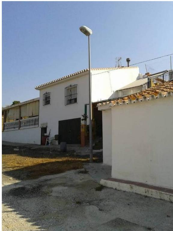
La farola nº 2 se compone de columna de acero galvanizado de 3,5 m de altura con luminaria marca Salvi modelo Basic Top II:
