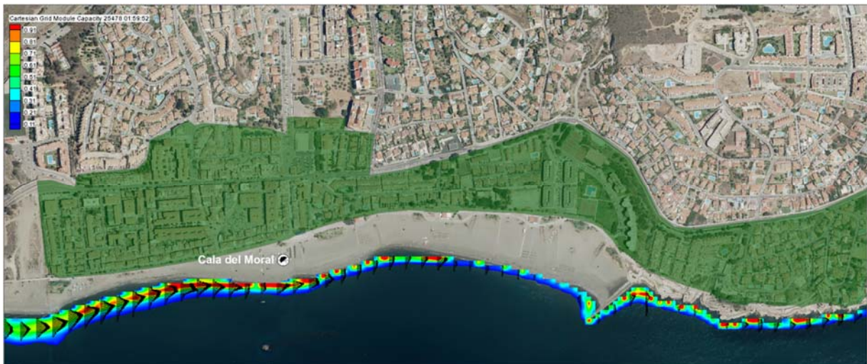
figura 93 Potencial de transporte de sedimentos (levante, Cala del Moral)
