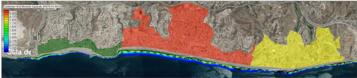
figura 92 Potencial de transporte de sedimentos (poniente)
